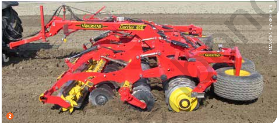
1 De TopDown is multifunctioneel inzetbaar. Je hebt slechts één werktuig nodig voor meerdere toepassingen. De aankoopprijs is navenant. 2 De Carrier is een compactschijveneg met vooraan een snijmolen. Deze cutter snijdt het 'droge' gewas alvorens het door de schijveneg nog eens verkort wordt. De vertering versnelt en de mogelijke verstoppingen worden gereduceerd.
